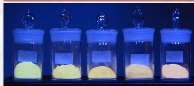
Набор образцов люминофоров в ряду составов Y_3Al_5O_{12}:Ce – Y_{1,5}Gd_{1,5}Al_5O_{12}:Ce при подсветке синим светодиодом (длина волны максимума излучения – 460 нм).
