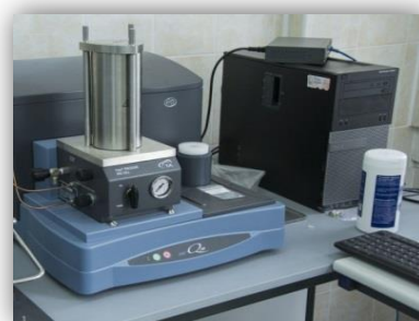
Дифференциальный сканирующий калориметр DSC Q20P с ячейкой высокого давления.
