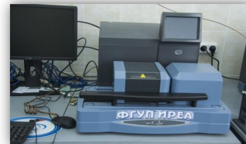
Дифференциальный сканирующий калориметр DSC Q20P с ячейкой высокого давления.
